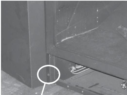
Façade sécuriser au rebord inférieur de l'appareil.
