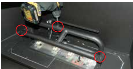
Schéma 2 : Faire glisser le dispositif du brûleur vers la droite, puis l'enlever.
