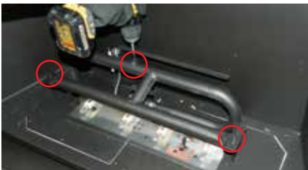
Schéma 2 : Glisser le brûleur vers la droite et l'enlever
