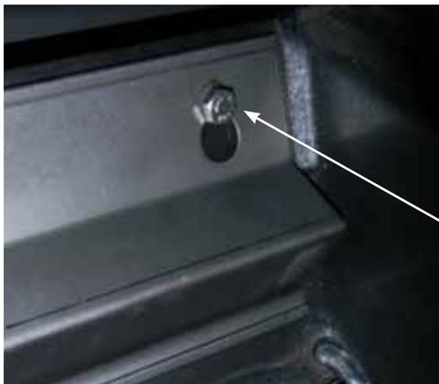
*S'assurer que le déflecteur est en place avec les boulons situés dans la partie supérieure du trou de serrure avant de serrer. Serrer les boulons seulement à la main.*
