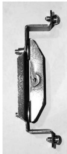
*Dispositif de verrouillage assemblé à nouveau avec des rondelles d'espacement en moins*
