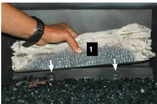
Installation de la bûche 1
