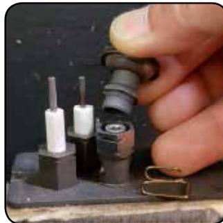
8. Dévisser l'orifice de la veilleuse à l'aide de la clé Allen fournie et le remplacer par l'orifice de la veilleuse pour propane fourni avec la trousse --remplacer le capuchon de la veilleuse.
