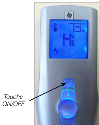
Schéma 2 - Télécommande en mode manuel sur "Hi"
