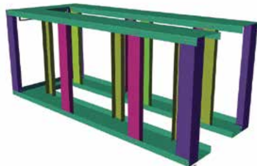
Schéma 8 - Installer les supports verticaux extérieurs (B1) à l'aide de 4 vis chacun.
