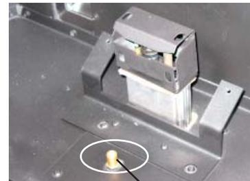
Schéma 7 Burner Orifice
