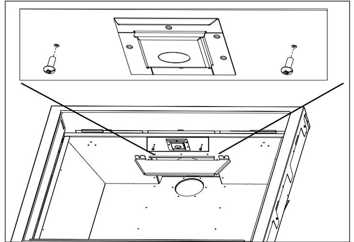
5. Retirer la plaque de recouvrement de l'éclairage supérieur en le soulevant pour le sortir.
