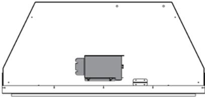
17. Dévisser les deux vis qui fixent la plaque de recouvrement au support IFC, puis l'enlever.
