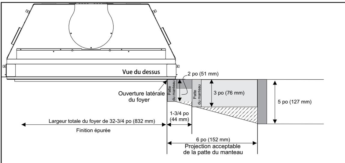
Voir les dimensions de la structure d'encadrement à la page suivante.
