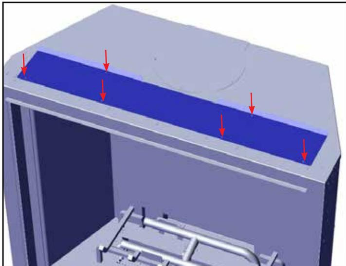
2. Retirer l'isolation du dessus de l'appareil et le mettre de côté.
