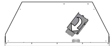
16. Tirer la boîte IFC vers l'avant de l'appareil avec les deux vis en vue.
