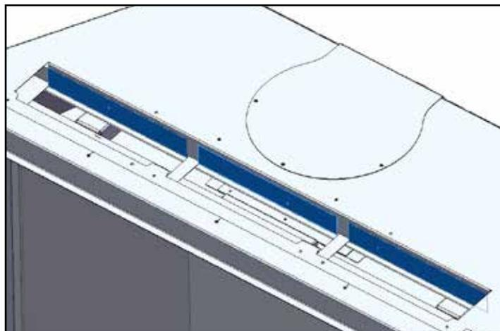
6. Faire pivoter le panneau supérieur de 180° et le réinstaller sur le dessus de l'appareil à l'aide de quatre (4) vis aux endroits indiqués ci-dessous.
