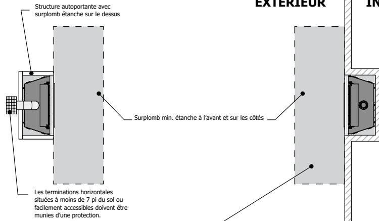
Le surplomb minimal à l'abri des intempéries devant et sur les côtés du foyer est égal à la moitié de la hauteur du surplomb (comme indiqué avec une hauteur d'encadrement de 96 po), mesurée à partir de la base de l'appareil.
