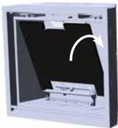
5. Desserrer les vis et retirer l'attache à briques.
