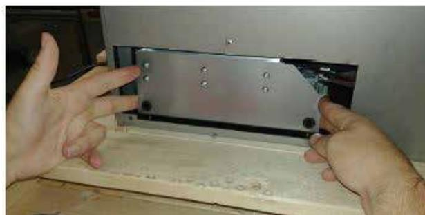
7. Fixer de nouveau le panneau d'accès au ventilateur sur l'appareil à l'aide de 4 vis (emplacements indiqués ci-dessous).
