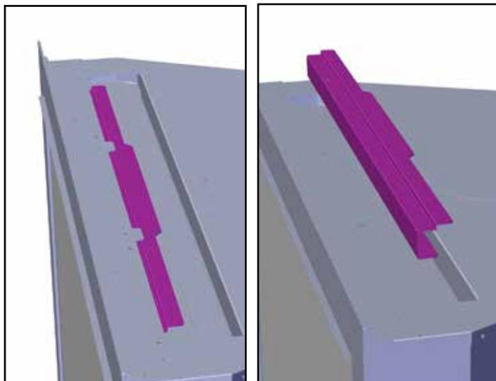
4. Insérer un grand tournevis plat dans la fente entre les onglets avant et arrière. Plier les trois (3) onglets de 90° vers l'avant de l'appareil. NE PAS ENLEVER LES ONGLETS
