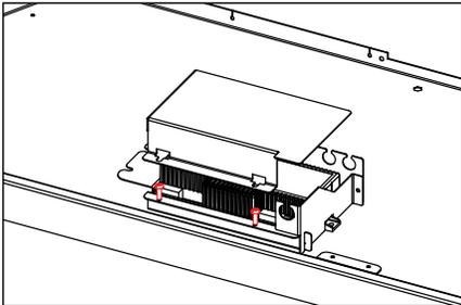
18. L'IFC peut maintenant être glissé hors de la chambre de combustion.
