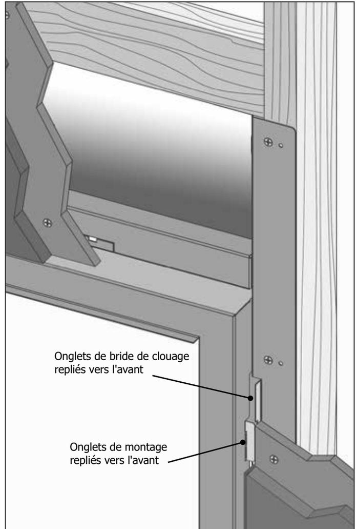
Installer la façade en posant ses bras sur le dessus des onglets de montage.
