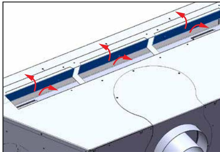
5. Plier les trois (3) onglets arrière de 90° vers l'arrière de l'appareil.
