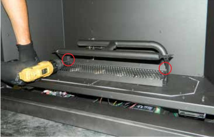
3. Soulever et faire glisser la plaque de recouvrement de l'éclairage vers l'avant pour le retirer.
