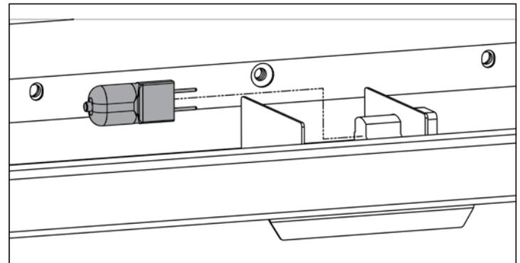
8. Inverser les étapes pour réinstaller. **REMARQUE :** Veiller à ne pas pincer le câblage lors de la réinstallation de la plaque de recouvrement de l'éclairage supérieur. Il y a une ouverture pour le passage du câblage.
