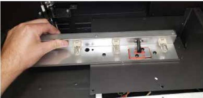
9. Soulever le panneau d'accès avec le dispositif d'éclairage et le mettre de côté.
