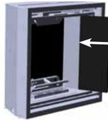
7. Une fois le panneau en place, le fixer à l'aide de la pince à briques retirée à l'étape 5 et serrer la vis.
