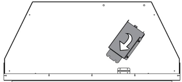
8. Tirer la boîte IFC vers l'avant de l'appareil avec les deux vis en vue.
