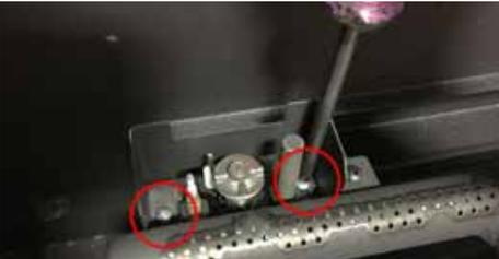
4. Installer soigneusement le panneau arrière. Incliner le panneau vers l'avant à partir du haut et reposer le bas du panneau sur le plancher de la chambre de combustion. Basculer la partie supérieure vers l'arrière jusqu'à ce qu'elle repose également sur le mur arrière de la chambre de combustion.
