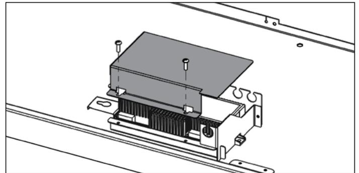
10. L'IFC peut maintenant être glissé hors de la chambre de combustion.
