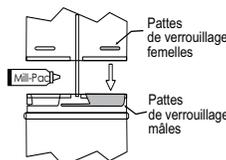
**REMARQUE :** Pour de meilleurs résultats et une performance optimale d'un système d'évacuation homologué, il est vivement recommandé d'appliquer du scellant Mill-Pac (fourni) sur la partie interne de chaque raccord de conduit. Le non-respect de cette procédure peut causer des problèmes de tirage et de performance qui ne sont pas couverts par la garantie.
