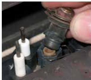
9. Dévisser l'orifice de la veilleuse à l'aide de la clé Allen, puis le remplacer par l'orifice de la veilleuse GPL fourni dans le kit.
