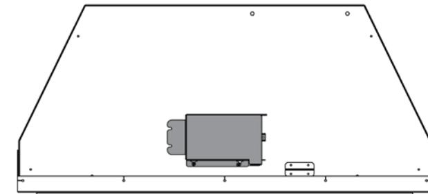
9. Retirer les deux vis qui fixent la plaque de recouvrement au support IFC. Enlever la plaque de recouvrement.
