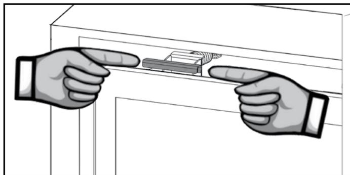
2. Lorsque les deux loquets sont déverrouillés, soutenir la porte avec les deux mains et incliner la porte vers l'extérieur jusqu'à un angle d'environ 60 degrés.
