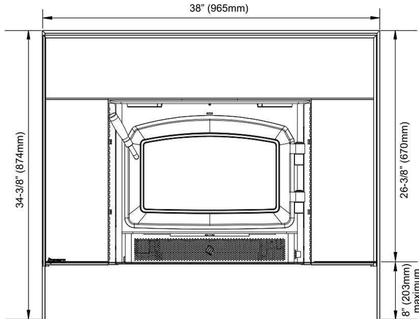
Dimensions de la façade grand format (illustration avec façade inférieure/support de ventilateur) :
