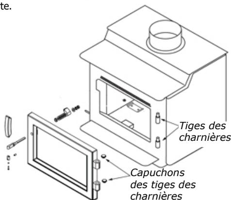
3. Retirer les écrous, les rondelles, la came et l'espaceur du dispositif de la poignée.
