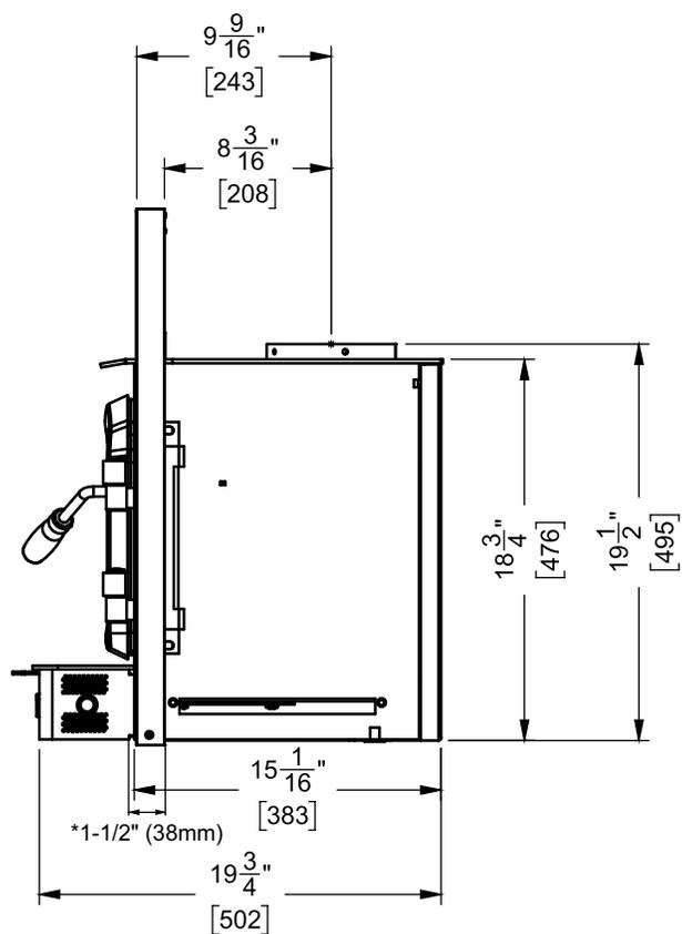
\* Mesure prise entre l'arrière de la façade et l'ouverture de la porte de chargement
