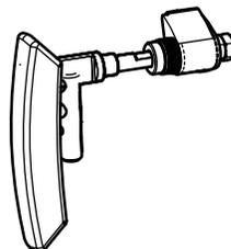
La poignée de porte froide au toucher est conçue pour être insérée de bas en haut et glissée lorsqu'elle n'est pas maintenue en place. Une fois en place, la porte peut être ouverte.
