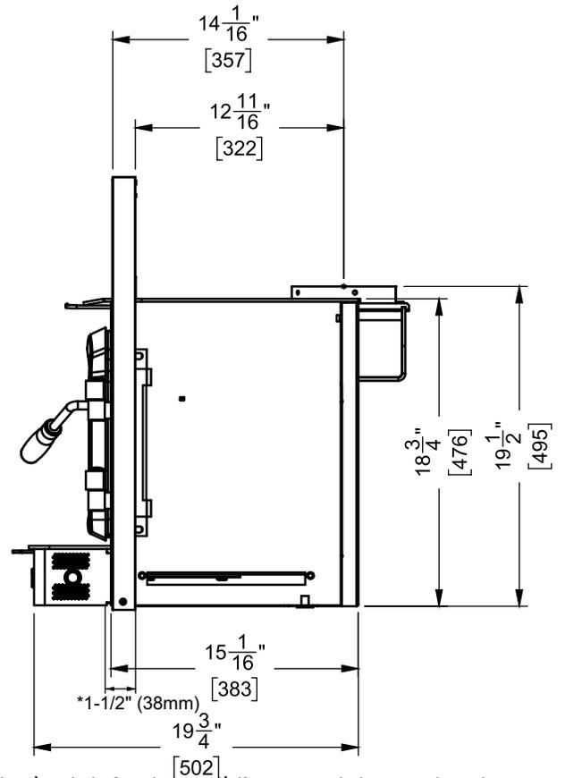
\*Mesuré de l'arrière de la façade jusqu'à l'ouverture de la porte de carburant.
