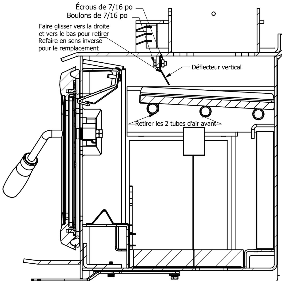
1. Retirer les 2 tubes d'air secondaire avant et les déflecteurs (détails sur la page 21).
