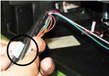
12. Fixer le récepteur au plancher de l'appareil à l'aide d'une bande velcro. Enlever le papier de protection sur la partie arrière de l'attache-câbles et placer avec soin les câbles dans l'appareil.
