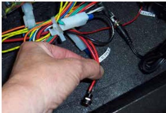
2) Brancher la cosse mâle de l'adaptateur CA à la cosse femelle qui porte l'étiquette "DC Supply" sur le faisceau de câbles de l'appareil.
