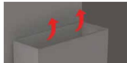
L'ouverture de ventilation peut être placée sur le dessus en s'assurant qu'elle respecte l'ouverture de 120 po<sup>2</sup>. Ce type d'ouverture de ventilation est utilisé lorsque le haut de l'enceinte est visible d'en haut et lorsque le plafond de la pièce est plus haut que la normale.
