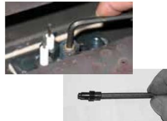
15. Réinstaller la coiffe de la veilleuse et la pince de retenue de la veilleuse.
