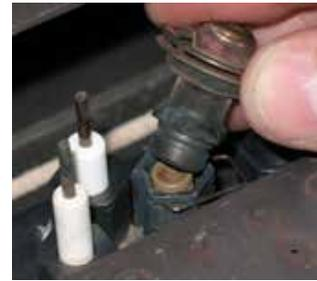
14. Dévisser l'orifice de la veilleuse à l'aide d'une clé hexagonale; puis le remplacer par l'orifice de la veilleuse et la coiffe de la veilleuse pour propane fournis dans la trousse.
