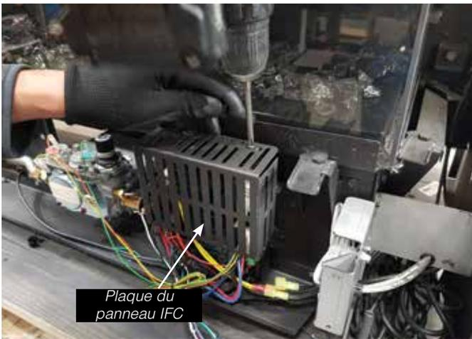
8. À l'aide des rondelles de verrouillage et des écrous fournis, attacher le fil de terre du câble BX à la prise de terre existante située à gauche du panneau de commande IFC.
