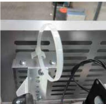
5. Connecter le fil de terra à la prise de terre située sur le mur latéral du boîtier du système d'évacuation forcée.
