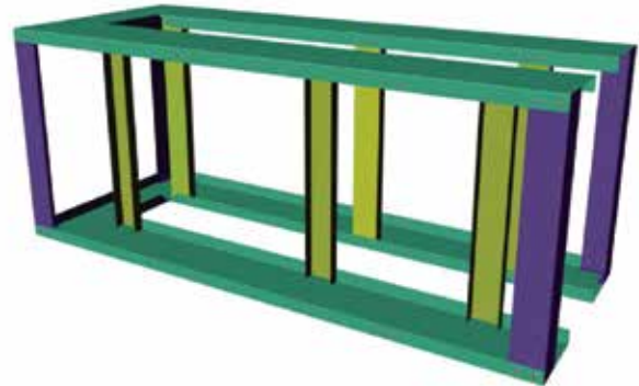
Schéma 6 - Installer les supports verticaux intérieurs
