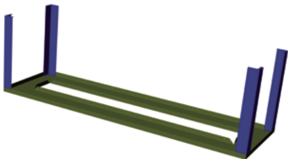
Schéma 1 - Supports d'angle sur le cadre inférieur.
