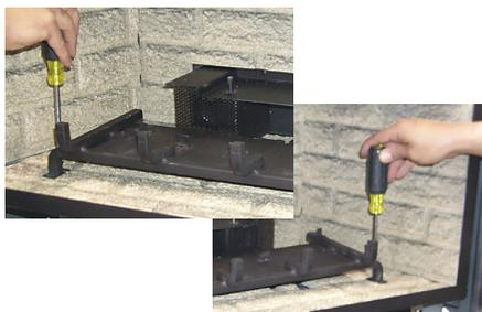
Schéma 1 : Retirer les vis sur la gauche et la droite puis faire glisser le dispositif du brûleur/de la grille vers la gauche et le soulever pour le dégager.
