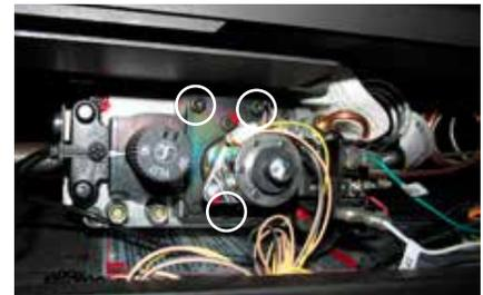
Retirer le moteur pas-à-pas au gaz naturel et le remplacer par le moteur pas-à-pas au propane
