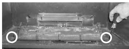
Retirer les 2 vis, pousser le dispositif du brûleur vers la gauche et le soulever.
