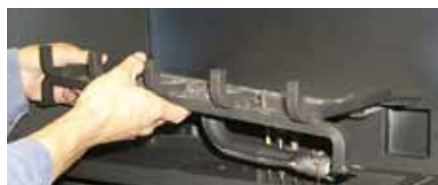
Schéma 1 : Dévisser les deux vis de chaque côté puis soulever le dispositif du brûleur /de la grille pour le sortir.
