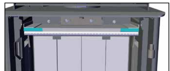
Fixations et plaques de recouvrement des déflecteurs dans leur emplacement définitif
