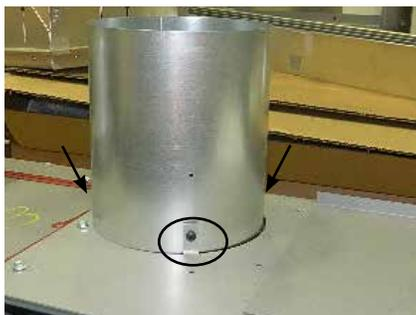
5. Connecter la gaine flexible à l'adaptateur à l'aide de 3 vis.
