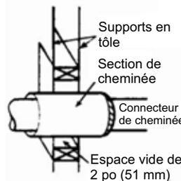
Dégagement minimal de 2 po (51 mm) de la cheminée aux supports en tôle et matériaux combustibles
