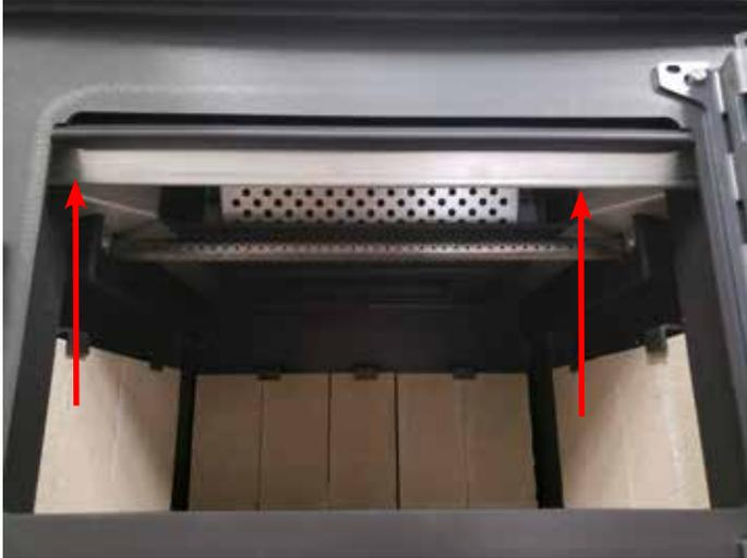
4. **Installation correcte** : S'assurer que le rebord de retour du déflecteur de fumée est placé avec le côté arrière du système de nettoyage de la vitre.
