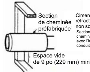
Dégagement minimal de 2 po (51 mm) entre la maçonnerie et les supports en tôle et matériaux combustibles
