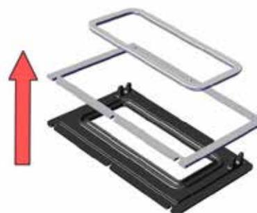
6. Pour réinstaller la trappe, répéter ces étapes dans l'ordre inverse, en veillant à insérer la tige dans la conduite de dérivation sur la trappe (Appareil illustré en transparence pour faciliter la compréhension de l'installation)
