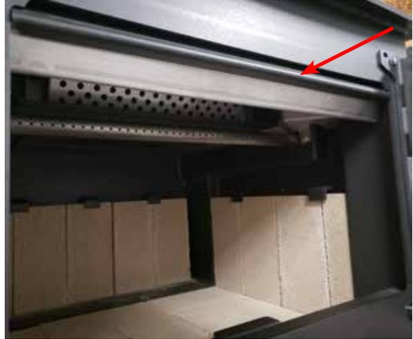
2. Pour remplacer le déflecteur, dévisser les deux boulons de 7/16 po et faire glisser le déflecteur vers le haut pour le sortir. Installer un nouveau déflecteur et serrer à la main les vis à tête hexagonale de 7/16 po. S'assurer que le déflecteur est bien en place avant de le visser.
