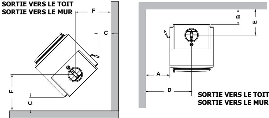
**REMARQUE :** Cet appareil est homologué pour être utilisé avec un conduit à paroi double. Ne pas utiliser de conduit à paroi simple.
