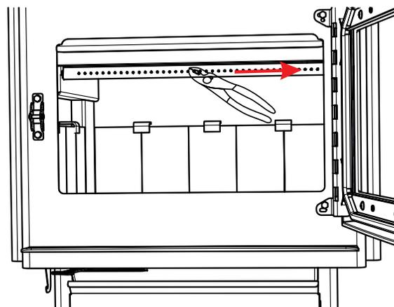
4. Pour réinstaller le tube d'air ou le remplacer, commencer par insérer son extrémité gauche dans la buse latérale gauche. Aligner ensuite l'encoche de son extrémité droite avec la languette de la buse latérale droite. Saisir fermement le centre du tube à l'aide d'une pince-étau puis frapper sur la pince avec un marteau, de gauche à droite, jusqu'à ce que le tube soit bien inséré dans la buse de droite.
