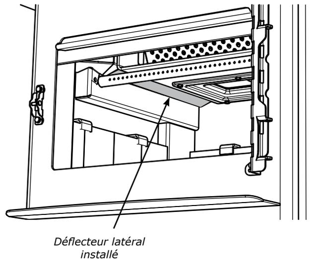
3. Faire glisser le déflecteur latéral sous le renfort de coin supérieur, de façon à ce qu'il repose sur la paroi latérale de la chambre de combustion.
