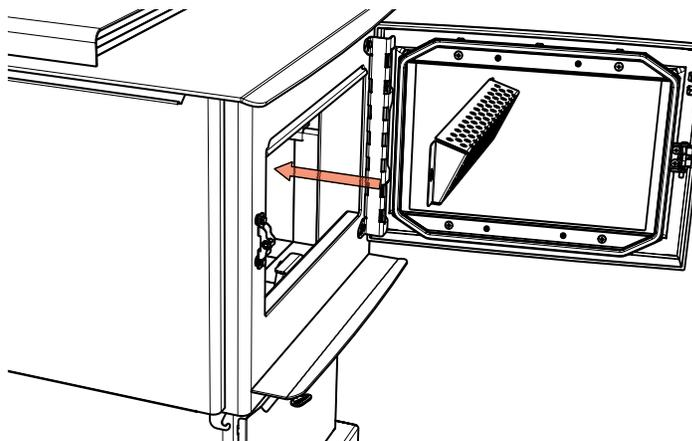
Pour réinstaller le pare-flammes, aligner ses trous en forme de fentes de serrure sur les boulons et le faire reposer sur ces derniers. Visser les boulons pour bien les ajuster, sans trop serrer. Lorsqu'il est bien installé – côté mince en bas et côté plus épais en haut – le pare-flammes crée un angle d'environ 45 degrés.
