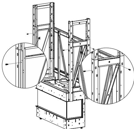
Installer les vis pour régler la hauteur des panneaux
