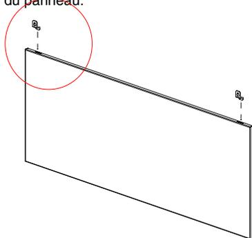
4. Installer le panneau du fond en émail - manoeuvrer le panneau à l'intérieur de l'appareil pour le placer sur la paroi du fond de la chambre de combustion.
