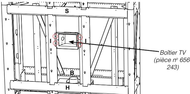
2. Installer le boîtier électrique dans le boîtier de la TV à l'aide de 2 vis—voir plus bas.
