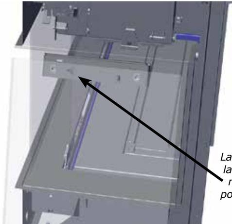
La flèche située sur la fixation du panneau latéral doit pointer vers l'avant de l'appareil.
