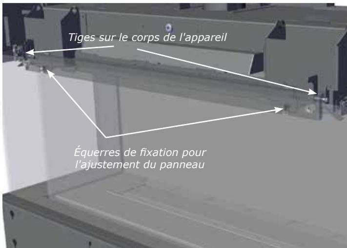
**Remarque :** Si les panneaux vitrés extérieurs de sécurité ne sont pas à 90° et sont inclinés trop à l'avant ou à l'arrière, retirer le panneau et régler la vis de l'équerre de fixation du panneau. Tourner cette vis en procédant par 1/4 de tour - réinstaller le panneau pour vérifier qu'il est bien droit.
