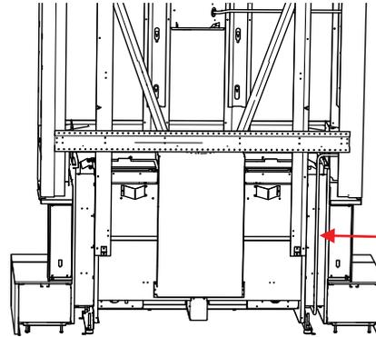
7. Faire passer les câbles requis (pour la TV, PVR, etc.) dans le tube prévu à cet effet. Une fois les câbles insérés, faire passer l'extrémité du tube + les câbles par le haut du boîtier électrique.
