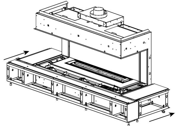
9. Mettre en place temporairement les matériaux de finition sur le dessus du socle et ajuster la hauteur du socle en réglant les pattes de nivellement pour s'assurer que les matériaux de finition sur le dessus du socle sont alignés avec les panneaux de la base extérieure sur l'appareil ou la bordure amovible si celle-ci est laissée en place (voir étape 7). Le nivellement doit se faire à l'avant et sur les deux côtés.
