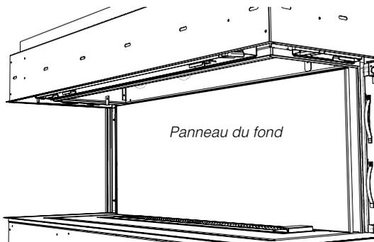
5. Fixer le panneau à l'aide des 2 attaches et de 2 vis.
