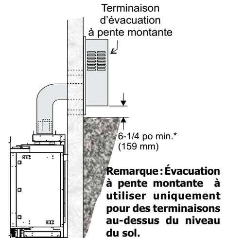
Remarque : Évacuation à pente montante à utiliser uniquement pour des terminaisons au-dessus du niveau du sol.
