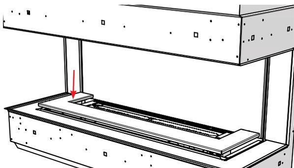
3. Installer les attaches du panneau dans les encoches prévues à cet effet sur le dessus du panneau.
