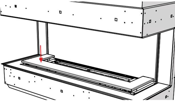
2. Installer les attaches du panneau dans les encoches prévus à cet effet sur le dessus du panneau (voir ci-dessous).
