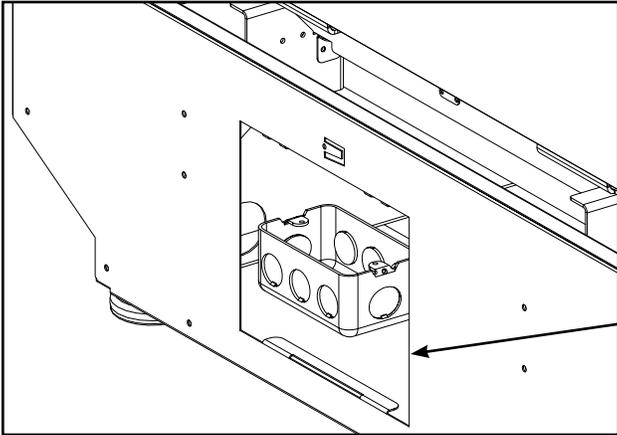
**REMARQUE** Cette ouverture n'est pas celle figurant sur l'appareil. Une ouverture a été pratiquée pour montrer l'emplacement du boîtier métallique de la prise de courant.
