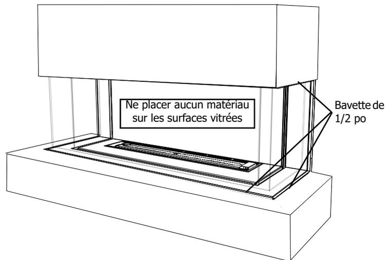
Remarque : Un tournevis coudé est fourni avec l'appareil pour faciliter le retrait/l'installation des bavettes.
