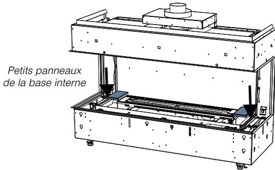
4. Glisser les fixations fournies derrière les petits panneaux et la paroi du fond en orientant les pièces selon le schéma ci-dessous.
