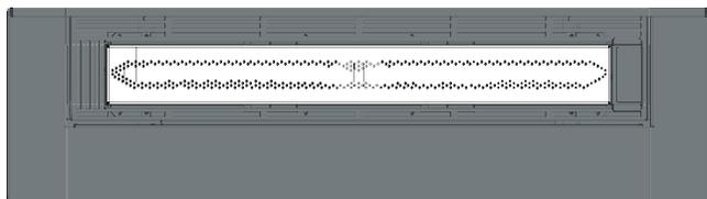
3. Placer les boulets de différentes tailles comme illustré ci-dessous. S'assurer qu'ils ne recouvrent aucun des orifices du brûleur.
