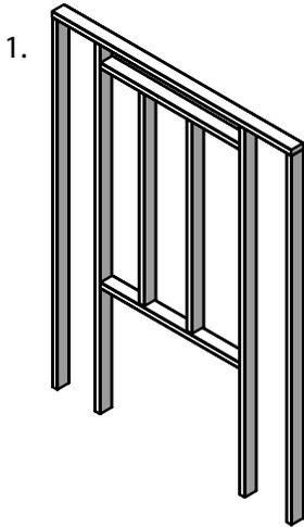
Ouverture de la structure d'encadrement pour l'évacuation
