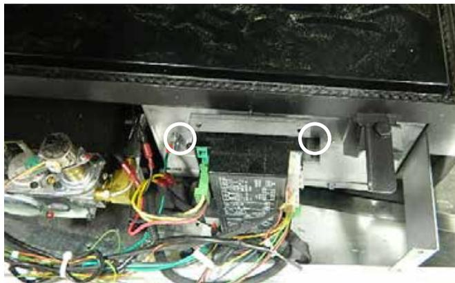
7. Retirer et mettre de côté les 2 vis du régulateur de pression A à l'aide d'un tournevis T20 ou à fente, le régulateur de pression B, le ressort et le diaphragme C.
