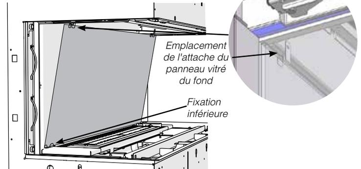
7. Réinstaller les panneaux vitrés en céramique de la chambre de combustion.
