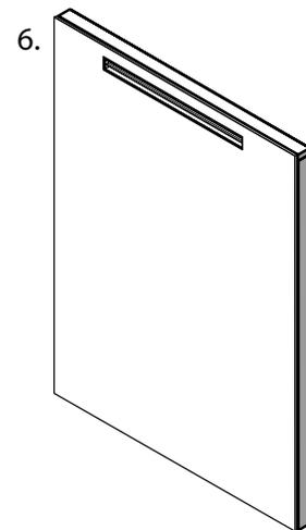
Découper une ouverture dans le matériau de finition, à l'intérieur de l'évacuation du châssis. Finaliser les rebords autour de l'ouverture.
