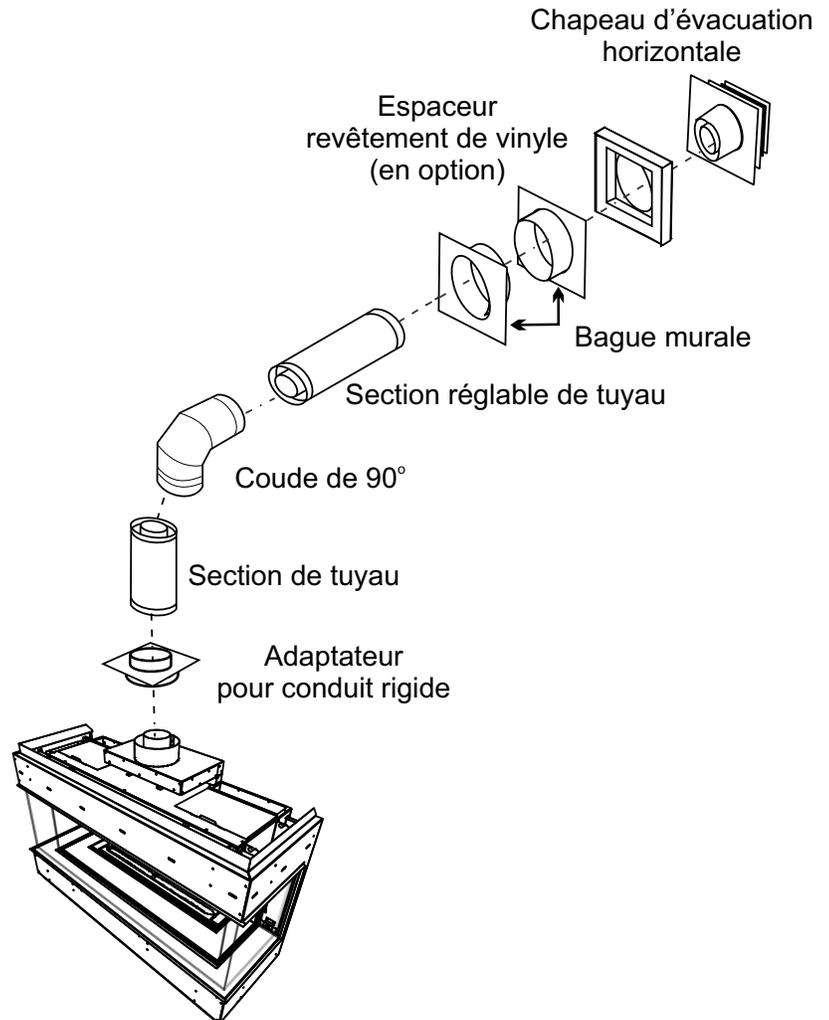
**Pour tout système d'évacuation rigide (sauf Simpson Dura-Vent), le conduit rigide doit être fixé à l'adaptateur à l'aide de 3 vis.**
