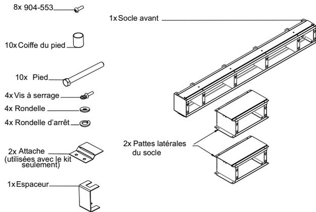
1. Commencer par le socle avant — le tourner à 90° (côté saillant sur le dessus) pour faciliter l'installation des pattes de gauche et de droite.
