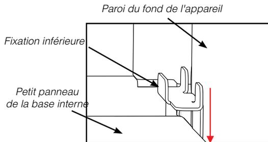
5. Installer le panneau inférieur en métal de la base (2) - Répéter cette étape pour installer le panneau vitré inférieur (3) sur le panneau inférieur de la base.
