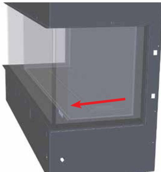
5. Soulever le panneau latéral à l'aide des ventouses fournies (voir la procédure à suivre à la page précédente). Incliner le côté du panneau vitré vers l'intérieur puis le soulever pour l'insérer sous le panneau latéral supérieur de l'encadrement extérieur et placer les 2 crochets extérieurs sur les tiges prévues à cet effet. Un troisième crochet se place également dans l'équerre de fixation du panneau.
