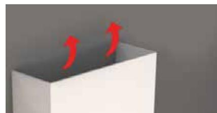
L'ouverture de ventilation peut être placée sur le dessus en s'assurant qu'elle respecte l'ouverture de 120 po<sup>2</sup>. Ce type d'ouverture de ventilation est utilisé lorsque le haut de l'enceinte est visible d'en haut et lorsque le plafond de la pièce est plus haut que la normale.
