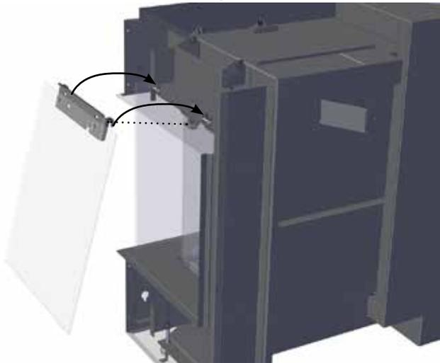
**Remarque :** Si les panneaux latéraux vitrés extérieurs de sécurité sont inclinés trop à l'avant ou à l'arrière, retirer le panneau vitré latéral et régler l'équerre de fixation du panneau. Voir détails sur la page précédente.
