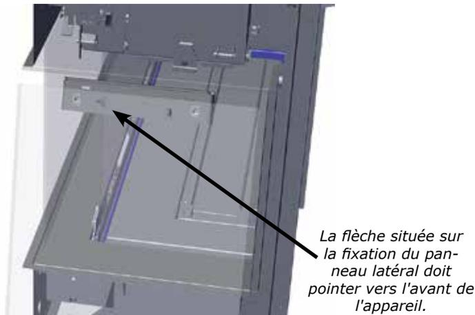
**Remarque :** Après avoir effectué le réglage du panneau latéral pour qu'il soit placé à un angle de 90° par rapport à l'appareil (sans basculer vers l'avant ou vers l'arrière), s'assurer qu'il n'y a pas de jeu entre le panneau avant et le panneau latéral. S'il y a un jeu, comme illustré ci-dessous, glisser le panneau latéral pour ajuster sa position et faire disparaître le jeu.
