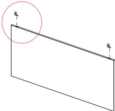
3. Placer le panneau du fond sur la paroi du fond de l'appareil. Le fixer à l'aide des 2 attaches de panneau et de 2 vis.
