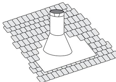
*Schéma 3 : installer la portion supérieure du solin au-dessous des matériaux de toiture et ne pas la fixer avant l'installation du conduit de cheminée. De petits ajustements pourront ainsi être effectués par la suite.*
