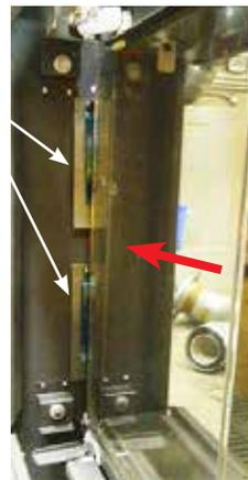
4. Une fois les ressorts comprimés, fermer les 2 brides du bas et les 2 brides du haut en les tournant vers l'intérieur pour fixer la vitre. Pour les foyers à 3 faces, répéter l'opération pour la face opposée.
