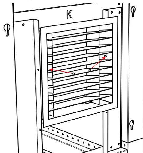
*Fixer la grille à l'aide des vis en passant par les grilles d'aération vers les côtés*
