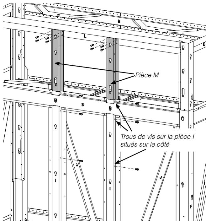
Trous de vis sur la pièce I situés sur le côté
