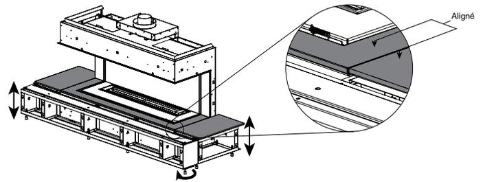
10. Enlever les panneaux de la base extérieure de l'appareil, puis fixer le socle à l'appareil à l'aide des 4 vis à serrage avec rondelles d'arrêt + rondelles (installées depuis l'intérieur de l'appareil) dans les emplacements indiqués ci-dessous (voir schéma).
