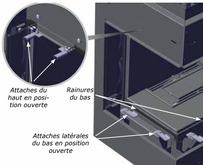
*Pousser fermement le panneau vitré latéral vers la paroi du fond, jusqu'à ce que les ressorts soient compressés - puis fermer les attaches.*
