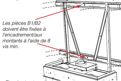
Les pièces B1/B2 doivent être fixées à l'encadrement/aux montants à l'aide de 8 vis min.
