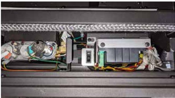
4. Repérer le branchement de la clé électronique WiFi (X0A) sur le côté du panneau IFC.
