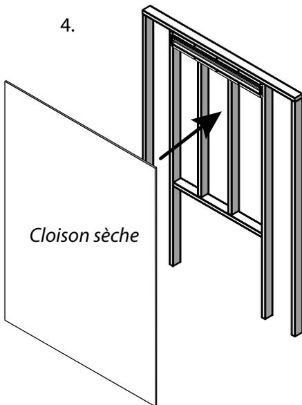
Construire la structure murale en utilisant un matériau de finition
