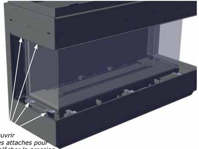
7. **Pour les appareils à 3 faces seulement :** Revenir au(x) panneau(x) latéral(aux), puis relâcher les attaches inférieure et supérieure pour détendre les ressorts. Pousser légèrement le panneau latéral vitré vers l'avant pour créer un joint d'étanchéité entre le panneau avant et le panneau latéral. Une fois les deux panneaux joints, fermer les attaches pour maintenir le(s) panneau(x) latéral(aux) en place.
