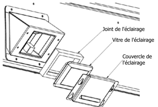
Ordre de réassemblage des plaques intérieures de recouvrement de l'éclairage
