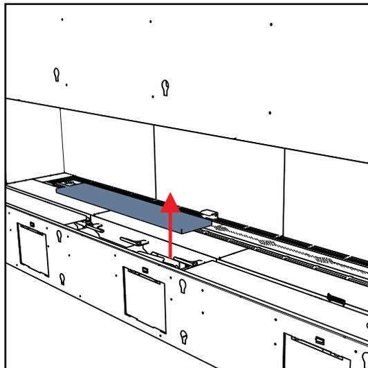
2. Depuis l'intérieur de l'appareil, pousser la languette vers l'intérieur pour dégager le panneau d'accès sur le dessus.
