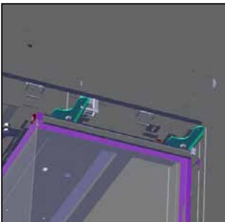
4. Déplacer avec précaution la partie inférieure du panneau vitré latéral dans la rainure du support, comme illustré sur le schéma ci-dessous.
