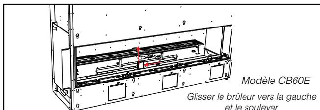
13. Enlever l'orifice du brûleur à l'aide d'une clé de 3/8 po. Utiliser une autre clé pour tenir le coude derrière l'orifice. Mettre de côté l'orifice. Réinstaller le nouvel orifice du brûleur pour propane n°50 et le serrer.
