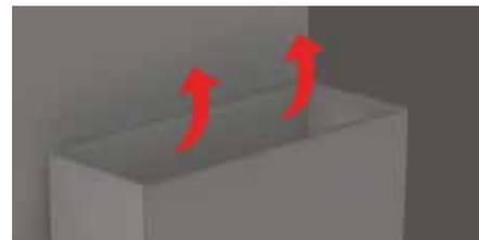
L'ouverture de ventilation peut être placée sur le dessus en s'assurant qu'elle respecte l'ouverture de 180 po<sup>2</sup>. Ce type d'ouverture de ventilation est utilisé lorsque le haut de l'enceinte est visible d'en haut et lorsque le plafond de la pièce est plus haut que la normale.
