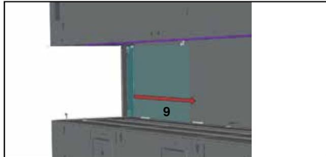
8. Fixer le dessus des supports de panneau à l'aide de 2 vis dans les 2 supports (2 supports pour chaque panneau).
