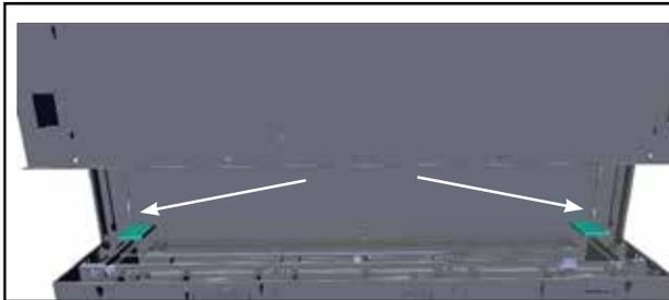
4. Installer les jeux de panneaux internes de la base (3/4, 5/6, 7/8), les panneaux en métal en premier, puis les panneaux vitrés sur le dessus.
