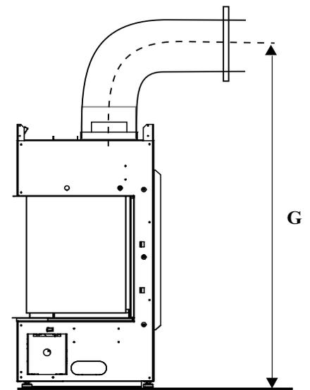
**Remarque :** Cet appareil doit être installé sur une surface solide, comme un sol fait en contreplaqué. Cette surface doit être de la même dimension (largeur et profondeur) que l'appareil.
