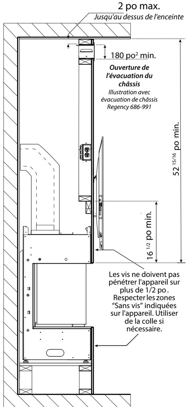
Remarque : Le support mural de la TV ne peut pas être fixé directement sur l'appareil. Il doit être fixé à la structure d'encadrement. La TV illustrée sur ce schéma peut se trouver plus haut selon le type de support mural utilisé. Le support mural illustré ici est une simple bande fixée à la structure d'encadrement.
