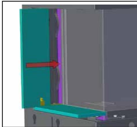
4. Installer le panneau de l'extrémité avant. Le placer sur l'appareil, comme illustré ci-dessous.
