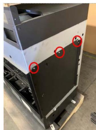
3. Visser la garniture amovible et plier les languettes au plus près de la garniture de finition vers l'intérieur à 90 degrés.
