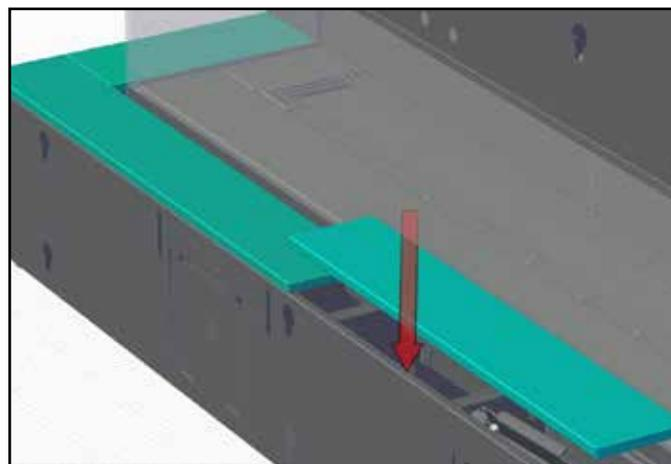
8. Une fois le jeu de panneaux installé, finaliser l'installation en mettant en place l'écran vitré.
