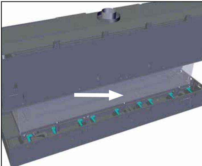
Attaches inférieures (x 9) en position ouverte la vitre.
