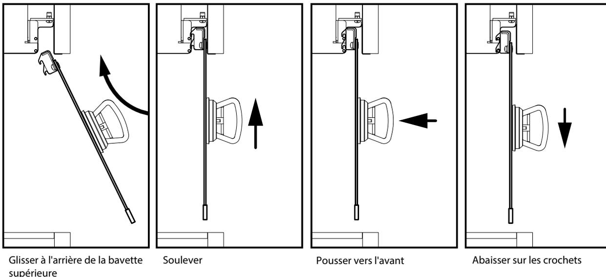
6. S'assurer visuellement que les crochets inférieurs reposent sur leurs tiges et que la vitre est de niveau et centrée dans l'ouverture.
