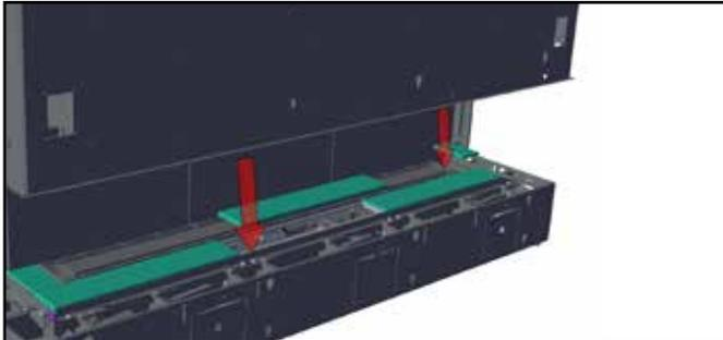
2. Sur la paroi du fond de la chambre de combustion, installer 6 vis (sans les serrer) dans les emplacements indiqués ci-dessous. Installer les 3 panneaux du fond. Suspendre les panneaux sur les vis installées en passant par l'ouverture en forme de serrure.
