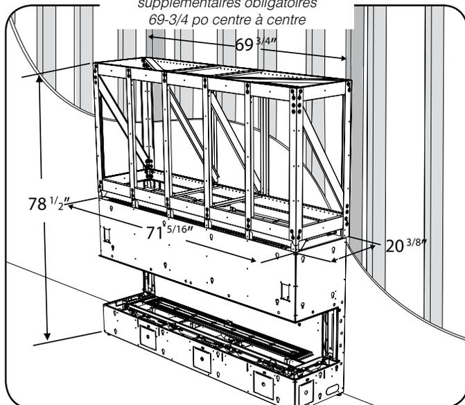
Dimensions totales - Ensemble de montage avec l'appareil
