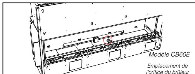
14. Retirer la pince de retenue de la veilleuse à l'aide d'une paire de tenailles et enlever la coiffe de la veilleuse pour dégager l'orifice de la veilleuse.
