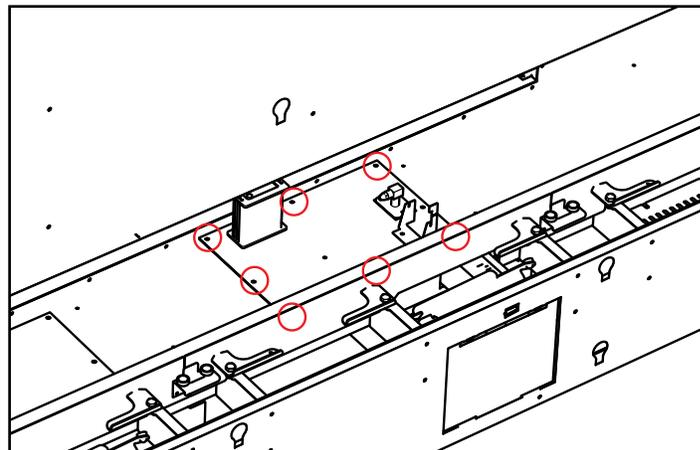
10. Soulever partiellement le plateau de la valve et débrancher la conduite flexible de gaz située sur le côté de l'entrée de la valve. Retirer le plateau de la valve et le remplacer par un nouveau plateau.
