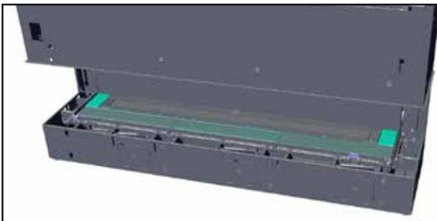
6. Installer les quatre supports du panneau du fond entre la paroi du fond et le plateau du brûleur. Aligner le centre des supports du centre une fois les panneaux de la base installés au cours des étapes précédentes, comme illustré ci-dessous.
