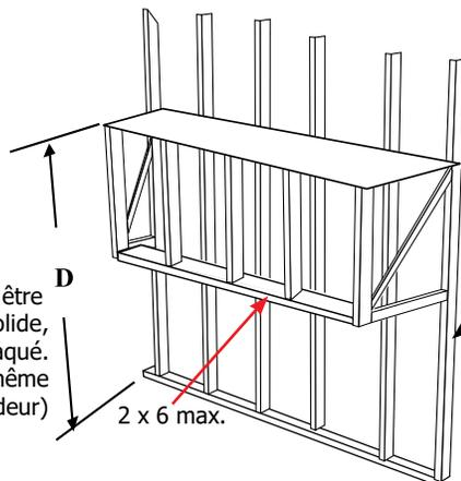
Remarque : Cet appareil doit être installé sur une surface solide, comme un sol fait en contreplaqué. Cette surface doit être de la même dimension (largeur et profondeur) que l'appareil.
