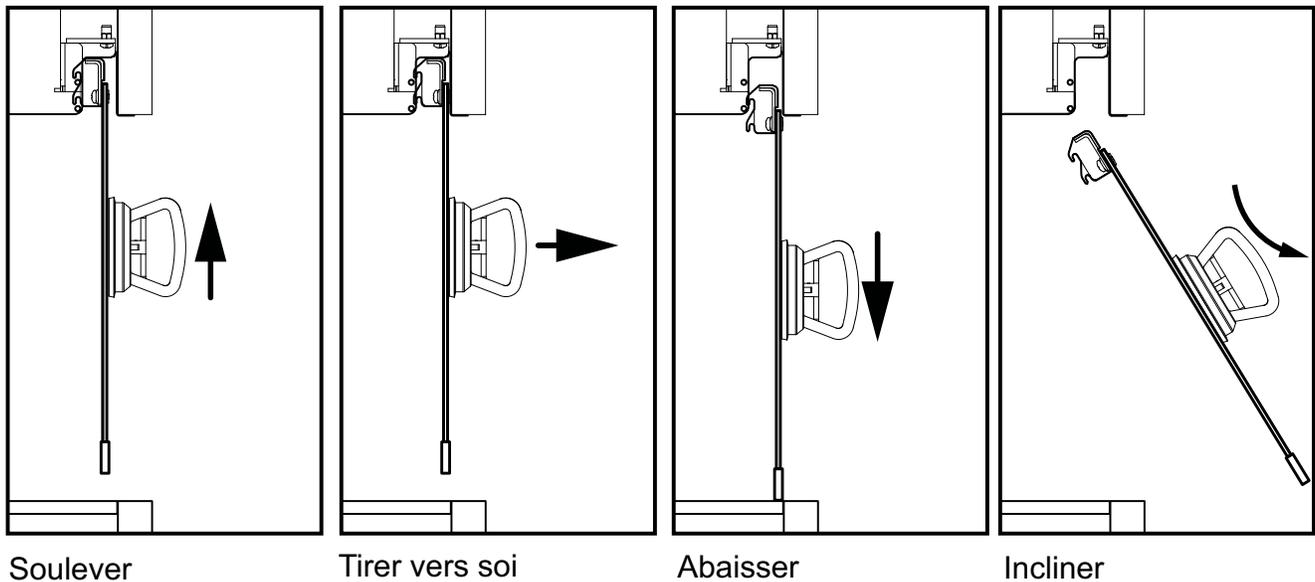
5. Incliner le bord inférieur vers soi et soulever l'écran vitré avec précaution en le posant sur la surface souple, à l'épreuve des rayures, préalablement préparée (par ex. un chiffon).
