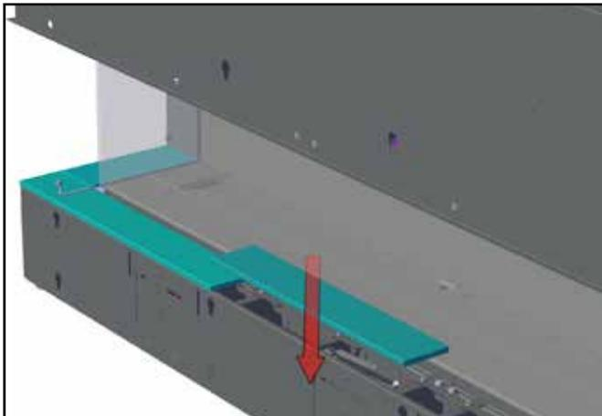
6. Installer le butoir de la vitre (si nécessaire) en glissant le dispositif du butoir entre l'appareil et le panneau. Le dispositif du butoir s'attache à l'appareil à l'aide d'un aimant. Le réglage de la position du butoir de la vitre est requis.
