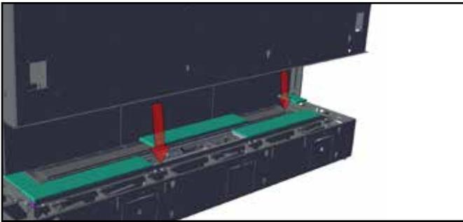
2. Sur la paroi du fond de la chambre de combustion, installer 6 vis (sans les serrer) dans les emplacements indiqués ci-dessous. Installer les 3 panneaux du fond et les suspendre sur les vis installées à travers l'ouverture en forme de clé de serrure.
