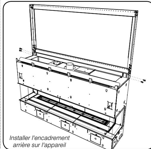
2. Installer l'encadrement assemblé à l'étape 1 à l'arrière de l'appareil comme illustré ci-dessus, à l'aide de 2 vis de chaque côté.
