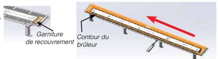
12. Dévisser 8 vis dans les emplacements indiqués ci-dessous (4 à l'avant et 4 à l'arrière) — faire glisser le brûleur sur la gauche, en l'écartant de l'orifice puis le soulever.
