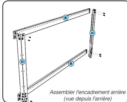
1. Assembler l'encadrement arrière, comme illustré ci-dessous, en assemblant 2 pièces B à 2 pièces H à l'aide de 8 vis installées depuis l'arrière de l'encadrement.
