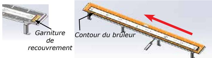
7. Dévisser 8 vis dans les emplacements indiqués ci-dessous (2 à l'avant et 2 à l'arrière) — faire glisser le brûleur sur la gauche, en l'écartant de l'orifice puis le soulever.
