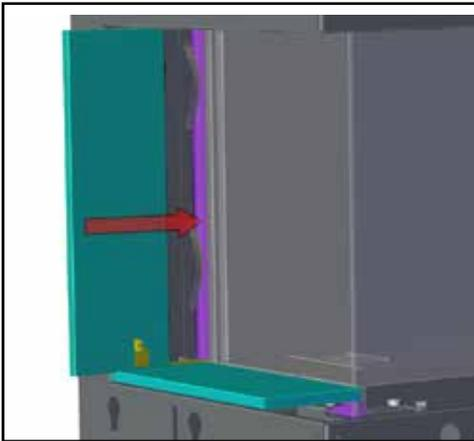
3. Installer le butoir de la vitre (si besoin) en faisant glisser le dispositif du butoir entre l'appareil et le panneau. Le butoir se fixe à l'appareil par un aimant : il est nécessaire de régler la position du butoir.
