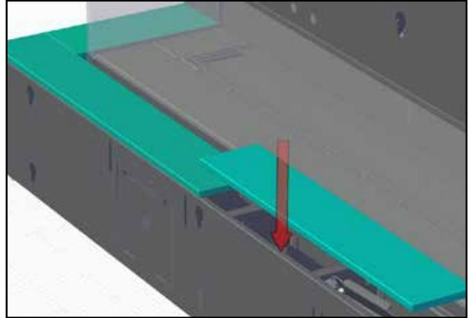
16. Installer le butoir de la vitre (si nécessaire) en glissant le dispositif du butoir entre l'appareil et le panneau. Le dispositif du butoir s'attache à l'appareil à l'aide d'un aimant. Le réglage de la position du butoir de la vitre est requis.
