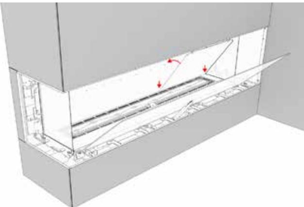
10. Installer le panneau interne pour la conversion en angle en le coinçant dans les panneaux inférieurs du revêtement intérieur. **REMARQUE : Le retour sur le panneau interne doit être sur le dessus, tourné vers l'intérieur, et le joint est tourné vers la vitre latérale.** **REMARQUE : La vitre latérale ne doit pas être retirée.**
