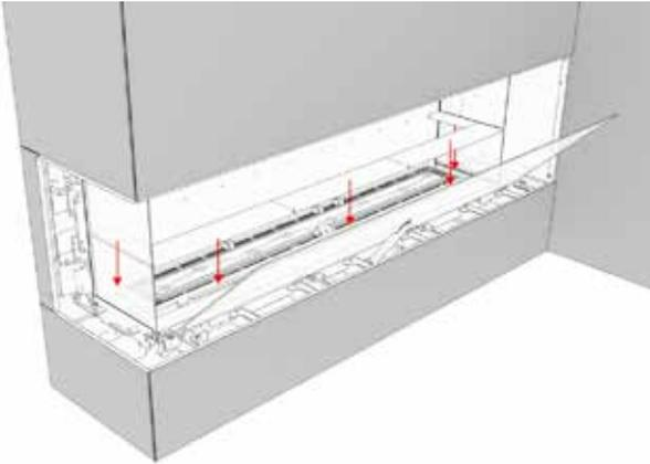
9. Installer les panneaux arrière en inclinant le bas de chaque panneau vers la base de la chambre de combustion, puis en les poussant vers l'intérieur.
