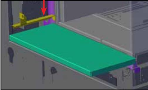
2. Faire glisser le panneau extérieur de la paroi du fond derrière la fixation du butoir de la vitre (s'il est installé).
