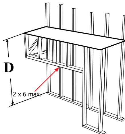
**Remarque :** l'appareil doit être installé sur un mur arrière solide - ne pas l'installer directement sur des montants.
