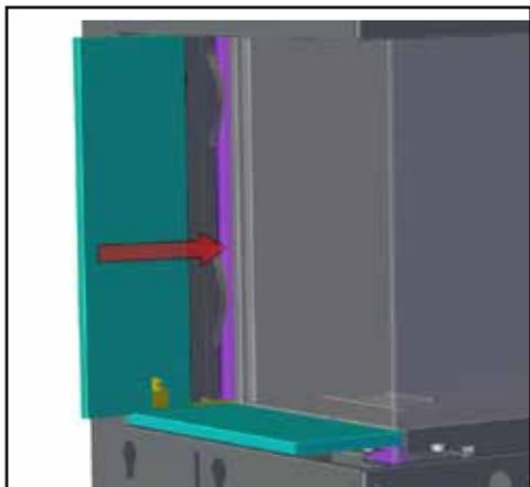
6. Installer le butoir de la vitre (si nécessaire) en glissant le dispositif du butoir entre l'appareil et le panneau. Le dispositif du butoir s'attache à l'appareil à l'aide d'un aimant. Le réglage de la position du butoir de la vitre est requis.
