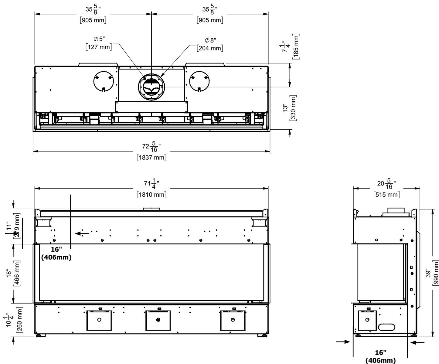
Remarque : La hauteur de l'appareil est mesurée lorsque les pattes de nivellement sont complètement insérées, et peut varier selon la hauteur des pattes de nivellement installées, dévissées ou étendues.
