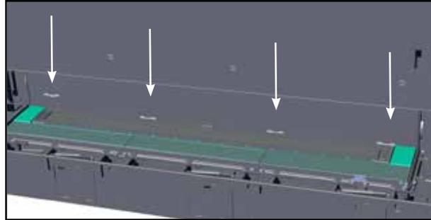
7. Manoeuvrer avec précaution les panneaux vitrés du fond (9,10,11) vers la paroi du fond de la chambre de combustion. Commencer par le panneau du fond 9. Placer les deux supports de panneau sur chaque panneau et les mettre en place en faisant glisser la partie inférieure du panneau dans les supports en coin et du fond.
