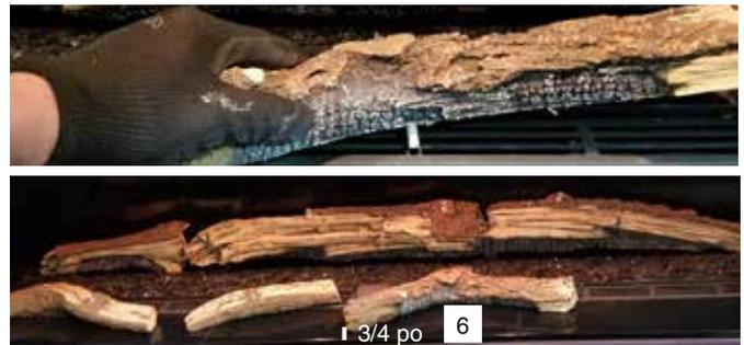
12. Insérer la tige de la bûche 7 dans le trou sur le côté extrême droit du brûleur. Placez l'extrémité gauche de la bûche 7 à 1-5/8 po du bord du panneau, tel qu'illustré ci-dessous.
