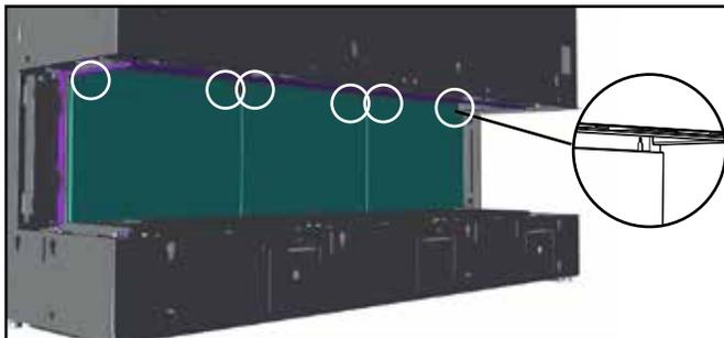
3. Réinstaller la vitre de la chambre de combustion, Voir les directives dans le manuel.
