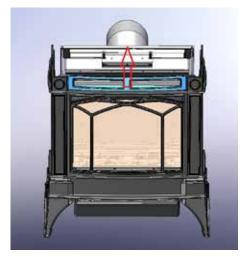
Retirer le dispositif de l'éclairage et le mettre soigneusement de côté. **5)** Dévisser les boulons de fixation de la moulure de la façade à l'aide d'une clé à douille de 7/16 po ou 11 mm.
