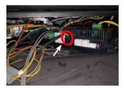
en retirant deux vis aux endroits montrés ci-dessous. Remplacer par un moteur pas-à-pas au propane liquide, puis le fixer à l'aide de deux vis. Remarque : il est vivement recommandé d'utiliser un embout Torx Y20 dédié avec un axe long afin de retirer les deux vis.
