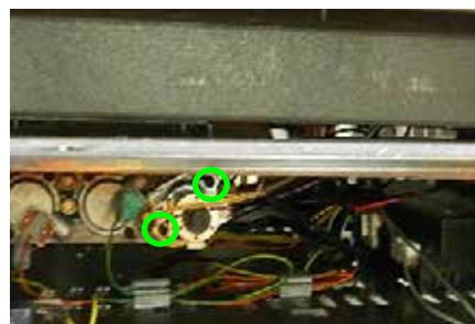
Retirer le moteur pas-à-pas au gaz naturel et le remplacer par le moteur pas-à-pas au propane
