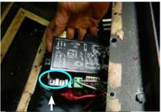
Débrancher les fils d'allumage au niveau du panneau IFC, branchés à la valve
