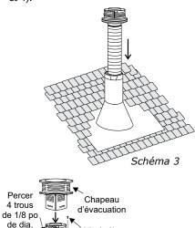
5) Tirer la gaine flexible vers le bas à travers le boîtier de support de plafond, jusqu'à ce qu'elle dépasse d'environ 3 po (76 mm). Raccorder la gaine flexible au rétroconnecteur en la glissant dans le manchon de 4-3/4 po (121 mm) de dia-mètre sur la partie supérieure du connecteur. Utiliser 3 vis à tôle pour assembler ces deux pièces.
