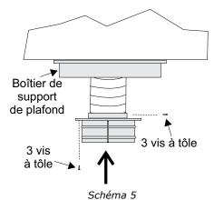
7) Le raccordement entre l'appareil et le rétroconnecteur peut être effectué avec des sections de conduit noir d'évacuation directe, dont la longueur est réglable.
