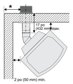
\*Si l'appareil est installé dans un coin extérieur, la distance minimale entre l'évacuation et le coin extérieur est de 6 po (15 cm). Voir «F» sur le schéma de la section « Emplacements des sorties d'évacuation extérieures ».
