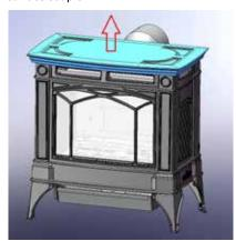
**3.** Dévisser les boulons de montage de la grille supérieure moulée à l'aide d'une clé à douille de 7/16 po ou 11 mm.
