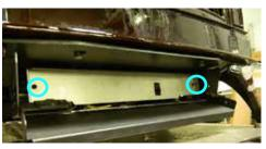
10) Débrancher les câbles du moteur pas-à-pas au gaz naturel au niveau du panneau IFC dans l'emplacement indiqué ci-dessous.
