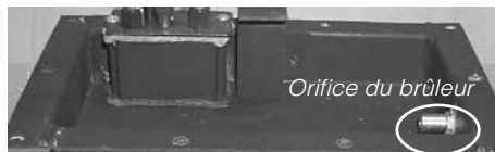
Retirer le moteur pas-à-pas au gaz naturel et le remplacer par le moteur pas-à-pas au propane
