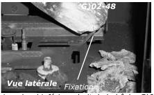
Le rebord inférieur droit de la bûche G)02-48 doit bien reposer contre la fixation. (La bûche avant 02-45 a été retirée pour mettre la fixation en évidence.)
