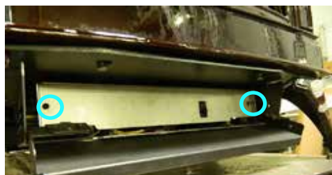
Retirer les 2 vis, pousser le dispositif du brûleur vers la gauche puis le soulever.
