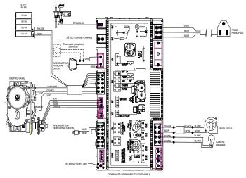
AVERTISSEMENT: Procédures de mise à la terre Cet appareil est équipé d'une prise de terre à trois broches pour une protection contre les chocs électriques. Cette prise doit être directement branchée à une prise à 3 fiches mise à la masse. Ne pas couper ni dévier le contact de mise à la terre de cette prise.
