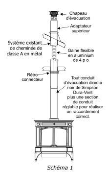
**3)** Raccorder l'extrémité de la section de gaine flexible à la partie inférieure de l'adaptateur à l'aide de 3 vis à tôle (voir schéma 2).
