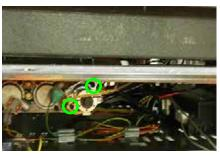
Retirer le moteur pas-à-pas au gaz naturel et le remplacer par le moteur pas-à-pas au propane
