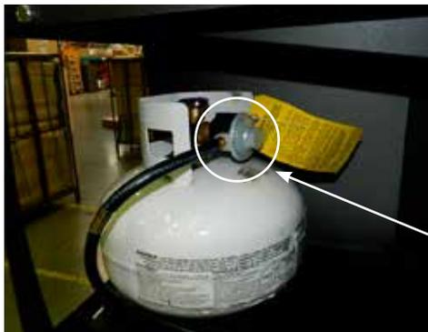
Raccordement du gaz à la bouteille
