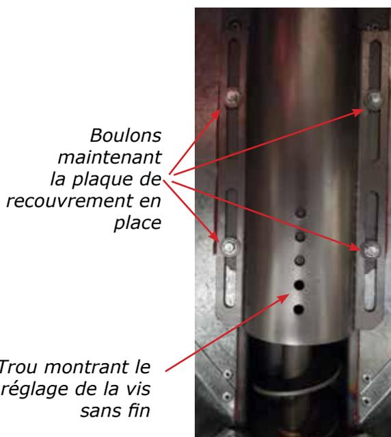
*Boulons maintenant la plaque de recouvrement en place*
