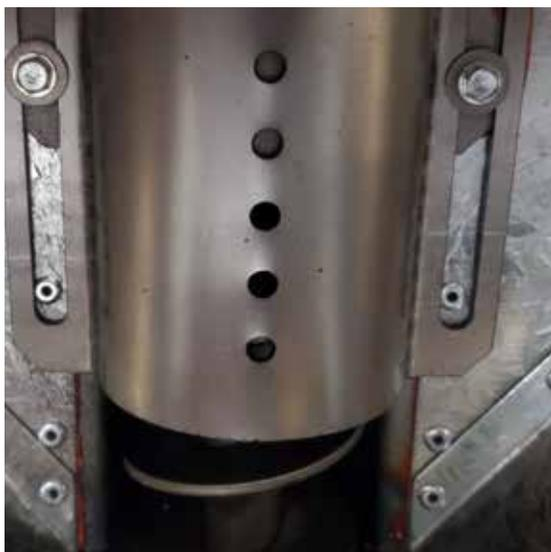
*Plaque de recouvrement de la vis sans fin de la trémie.
