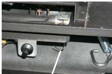
Câble de réglage de l'arrivée d'air
