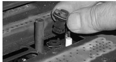
10. Dévisser l'orifice de la veilleuse avec la clé Allen et le remplacer par l'orifice de la veilleuse au propane qui se trouve dans la trousse de conversion.
