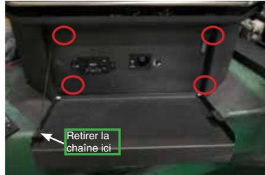
7. Mettre le bouton de commande sur la position "OFF" (Arrêt).
