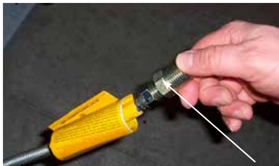
Schéma 14 Retirer le raccord
