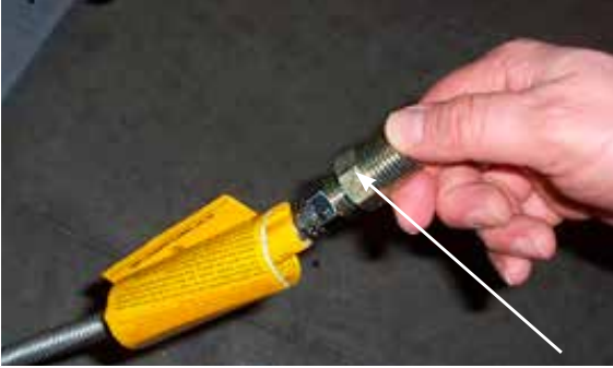
Schéma 14 Retirer le raccord
