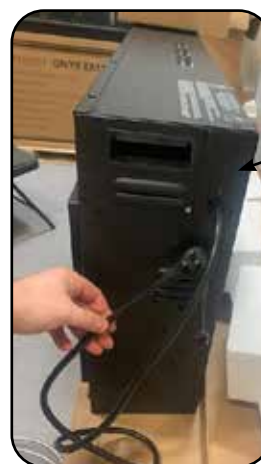
Faisceau de câbles et plaque de recouvrement réinstallés.
