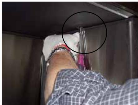
2) Installer ensuite un des panneaux latéraux (gauche ou droit). Le positionner avec la pliure du panneau face à l'extérieur ou face à la paroi de l'appareil, puis le fixer à l'aide d'une attache et d'une vis.
