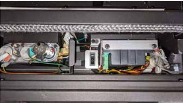
4. Repérer le branchement de la clé électronique WiFi (X0A) sur le côté du panneau IFC.
