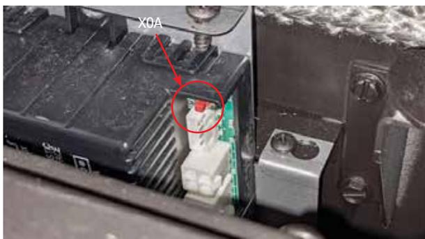
5. Aligner les languettes de la clé électronique avec les encoches situées sur le panneau IFC et insérer les fils dans le branchement.
