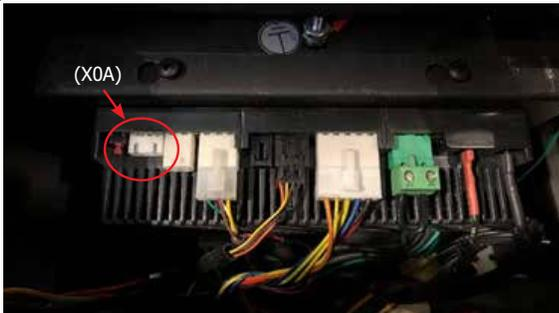
4. Aligner les languettes situées sur la clé avec les fentes du raccordement du IFC et insérer le câble dans le raccordement.
