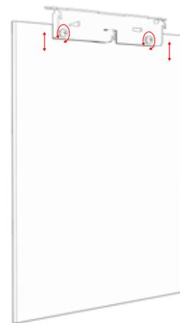
Pour ajuster la vitre latérale, enlever les vis en haut du panneau et déplacer la vitre vers le haut ou vers le bas. Lorsque la vitre est dans la bonne position, remettre les vis en place et les serrer.
