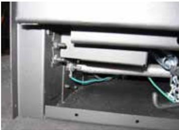
26) Y fixer une des extrémités du fil de mise à la terre vert à l'aide de l'écrou et du boulon fournis.
