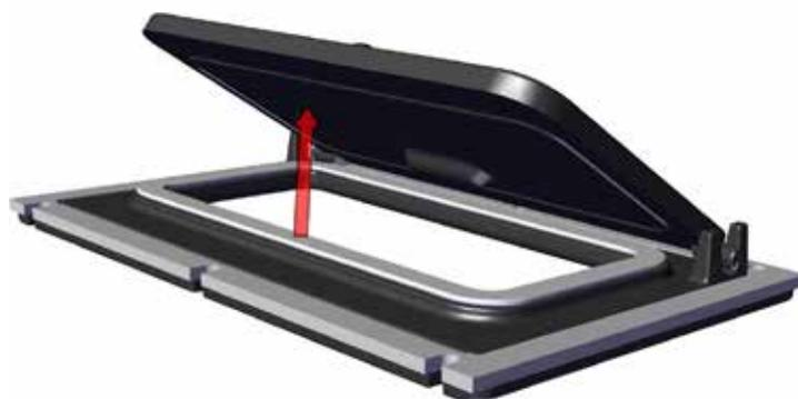
5. Enlever le joint usé et le remplacer par un neuf.
