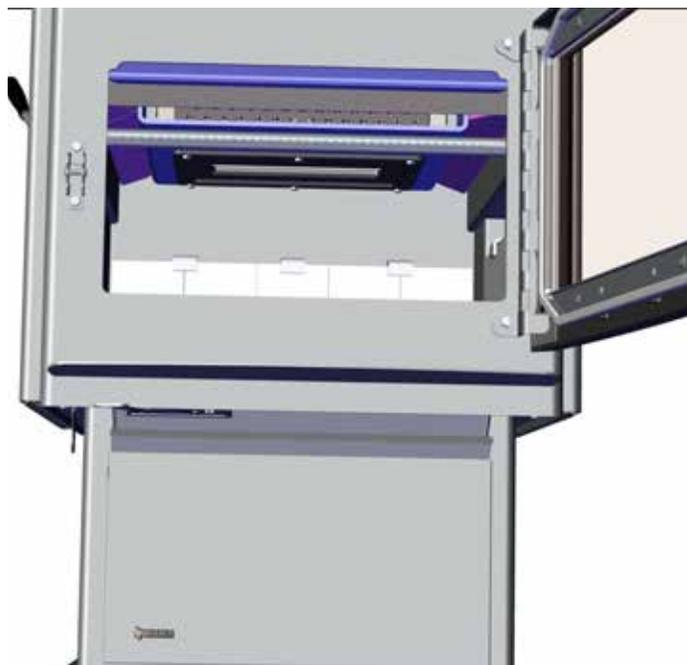
3. Dévisser les 3 écrous arrière, puis retirer les 3 écrous à l'avant. Soutenir la trappe du registre de dérivation à l'avant et à l'arrière et la faire glisser vers l'avant pour la retirer.
