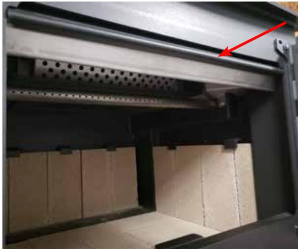
3. **Mauvaise installation :** le rebord de retour du déflecteur de fumée se trouve sous le système de nettoyage de la vitre.
