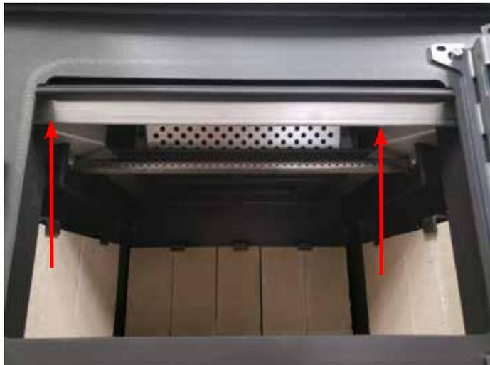
2. Pour remplacer le déflecteur, dévisser les deux boulons de 7/16 po et faire glisser le déflecteur vers le haut pour le sortir. Installer un nouveau déflecteur et serrer à la main les vis à tête hexagonale de 7/16 po. S'assurer que le déflecteur est bien en place avant de le visser.
