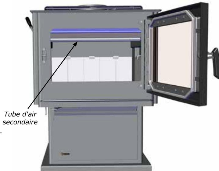
3. À l'aide d'une pince-étau, saisir fermement le tube d'air secondaire. Frapper sur la pince avec un marteau, de droite à gauche, afin de dégager et d'enlever le tube d'air.
