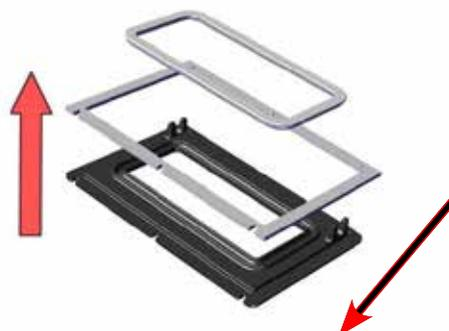
6. Pour réinstaller la trappe, répéter ces étapes dans l'ordre inverse, en veillant à insérer la tige dans la conduite de dérivation sur la trappe (Appareil illustré en transparence pour faciliter la compréhension de l'installation)
