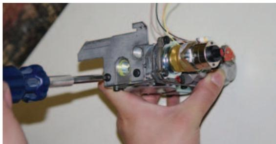
14) Remplacer la soupape et réassembler le tout en suivant la procédure ci-dessus en sens inverse.
