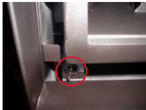
Le commutateur Surefire est discrètement situé dans le coin inférieur droit de l'appareil.
