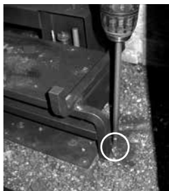
Schéma 1: Retirer les vis de gauche et de droite.
