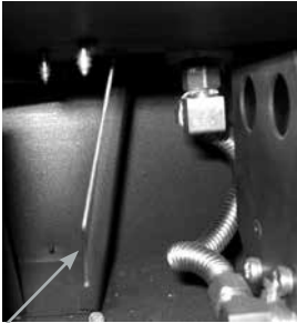
Tige de l'arrivée d'air - située à gauche de la valve
