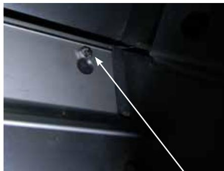
*S'assurer que le déflecteur est placé pour que les boulons soient situés dans la partie supérieure du trou de serrure avant de serrer.*
