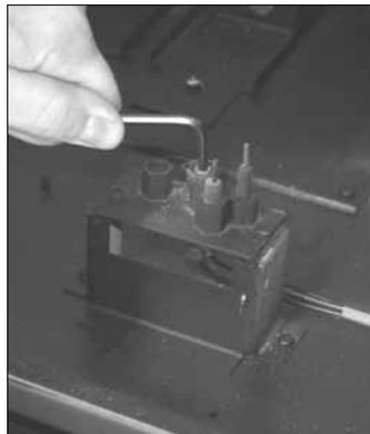
Schéma 38 : Retrait de l'orifice de la veilleuse.
