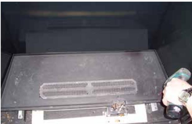
Schéma 49 : Emplacement des vis sur le brûleur
