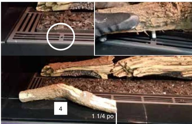
10. Insérer la tige de la bûche 5 dans le trou sur le côté gauche du pilote. Placez l'extrémité gauche de la bûche 5 à 1-3/8 po du bord du panneau.
