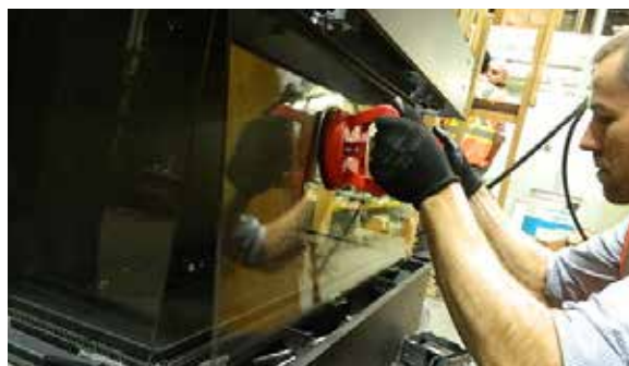
Manipuler le panneau avant à l'aide des ventouses fournies
