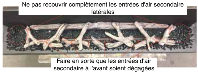
Positionnement correct du charbon noir
