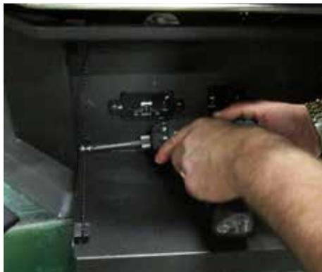
3. Retirer les quatre vis et la chaîne fixée à la porte avant et à l'appareil.
