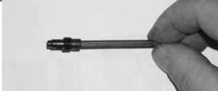
9. Dévisser l'orifice du brûleur à l'aide d'une clé plate de 1/2 po. Se servir d'une autre clé pour stabiliser le coude à l'arrière de l'orifice. Remplacer par l'orifice du brûleur n°54 inclus dans la trousse.
