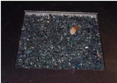
1. Propagation des cristaux uniformément sur le brûleur et firebox base.
