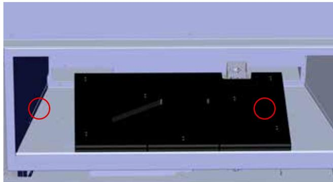
Schéma 3 - Emplacement des vis du brûleur
