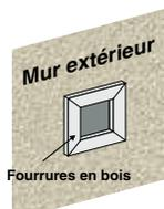
2. Ajuster la position de l'appareil et le fixer à l'enchâssure à l'aide de clous ou de vis par les brides de clouage situées sur les côtés de l'appareil.
