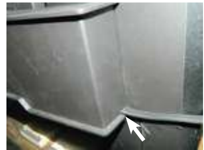
Rentrer le câble électrique dans le côté droit de la façade
