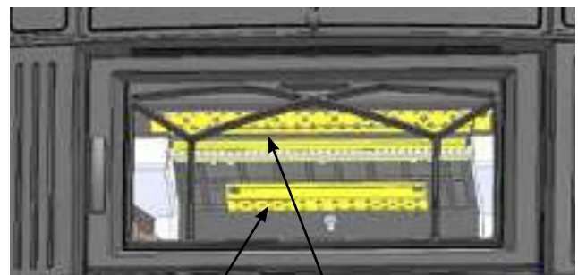
B - Pare-flamme du catalyseur - Desserrer les 2 boulons de 7/16 po pour les enlever. E - Écran inférieur
