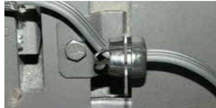
Fixer le dispositif anti-traction pré-réglé
