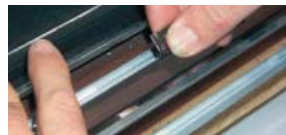
Enfoncer la plaquette de retenue sur la grille inférieure et l'ajuster pour qu'elle soit perpendiculaire à la grille.
