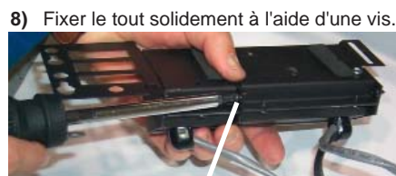
Schéma 3: Joindre le boîtier de commande et le commutateur en unissant la pince et le crochet fixés sur le côté de chacun d'eux.
