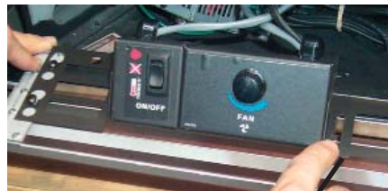
Tenir le module en place et marquer la position de la fente de la ferrure droite.
