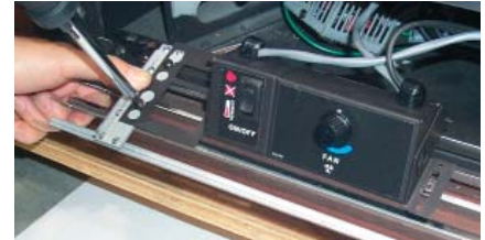
Visser la grille avec deux vis à gauche.
