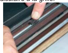
Enfoncer la plaquette de retenue sur la grille inférieure et l'ajuster pour qu'elle soit perpendiculaire à la grille.
