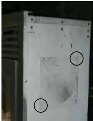
Retirer les 2 vis qui retiennent la plaque de couverture sur le côté du foyer.
