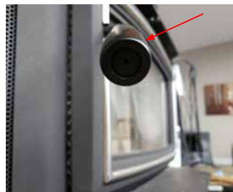
2. Dévisser la vis de la clé Allen de 7/64 po dans le sens antihoraire. Une fois la vis desserrée, la retirer et abaisser la poignée pour la dégager du manche et la remplacer par une nouvelle.
