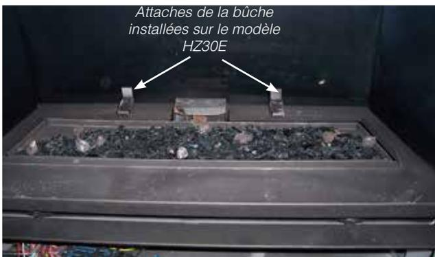
2. Mettre en place la bûche du fond (1) en plaçant le centre de la bûche sur le centre de la coiffe de la veilleuse. Faire reposer la bûche 1 sur les attaches de la bûche. Chaque extrémité doit reposer sur le rebord du plateau du brûleur, comme illustré ci-dessous.
